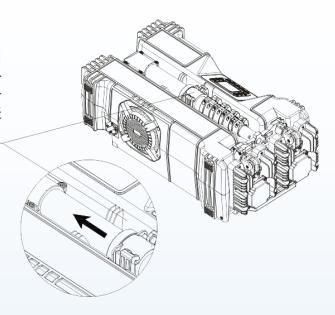
升降杆转动到竖起状态时,此时升降杆底部已锁紧固定;当用手向上扣动升降杆限位板,升降杆底部松脱,即可收起升降杆。
