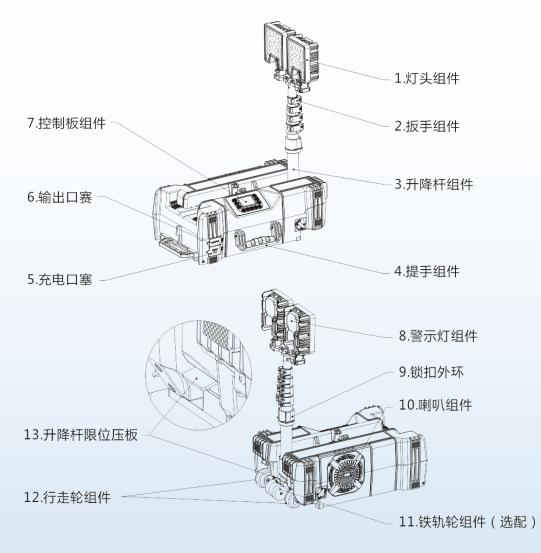
注:扳动扳手组件降低升降杆高度时,请勿用手放在组件内,以防降低过快压手;
